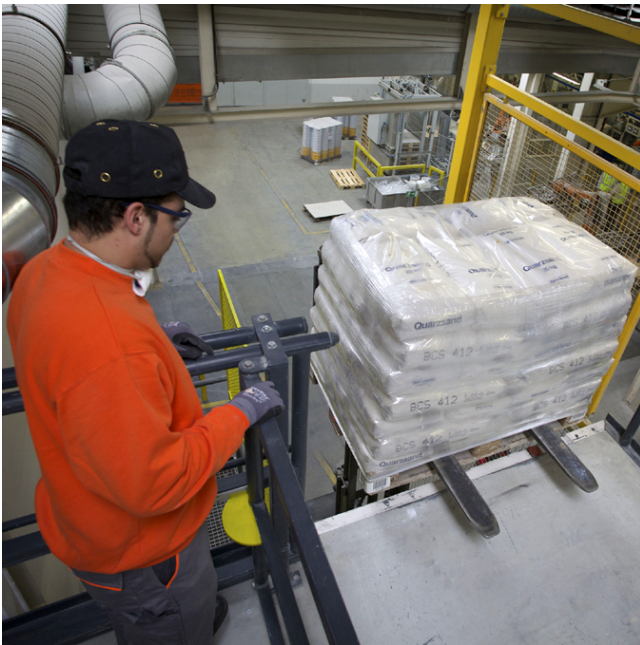
Absturzsicherung im betrieblichen Einsatz - Schiebetor geöffnet, Zugangstür mechanisch verriegelt
