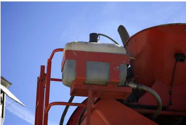
zu befüllender Fließmittelbehälter auf dem Fahrmischer
