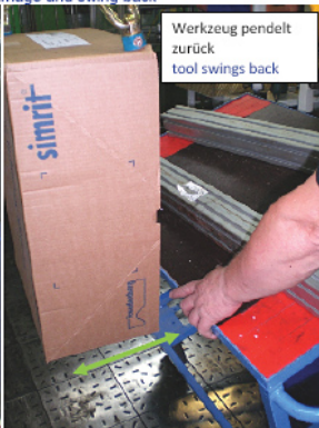
Werkzeug rutscht vom Wagen und pendelt zurück Tool slips from the carriage and swing back
