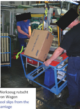
Werkzeug rutscht vom Wagen und pendelt zurück Tool slips from the carriage and swing back
