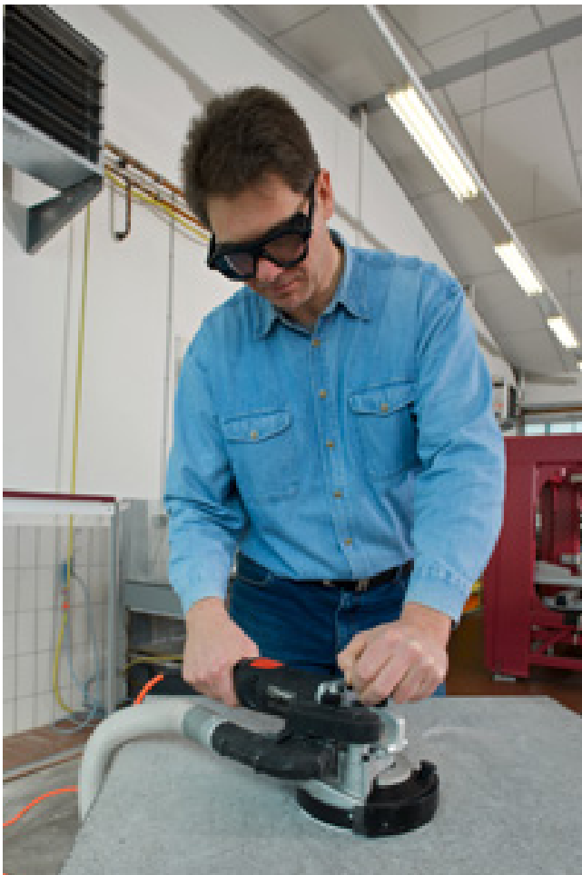
Staubabsaugung beim Schleifen einer Natursteinplatte
