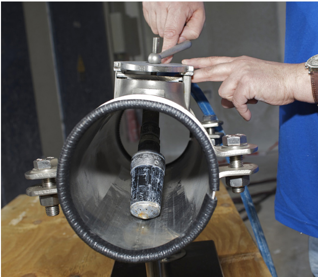
Basis des Systems sind ein standardisierter Deckel und eine Gewindestange mit angeschweißtem Steg. Foto: BG RCI/Plöger
